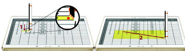
Figure 6 : Illustration de la technique Stylet : stack du smartphone (1) et translation (2) pour étendre la sélection.
