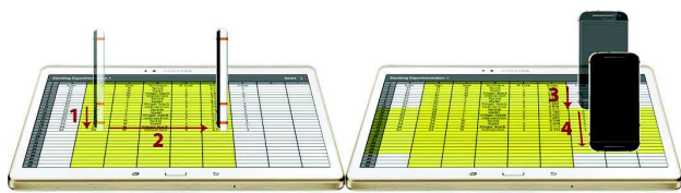
Figure 5 : Illustration de la technique Intersection: stack (1) puis translation (2) pour sélectionner les colonnes et stack (3) suivi d'une translation (4) pour sélectionner les lignes.
