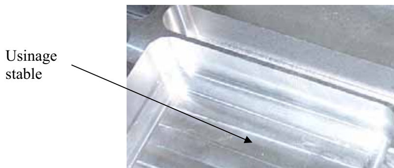
Fig. 10 : Usinage stable sur le fond avec l'outil ayant un rayon de bec de 0,15mm.
