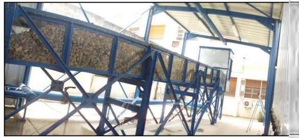
Figure 1 : Le canal construit à l'INAT : de longueur 10 m, de largeur 0.8 m, et de hauteur 0.6 m
