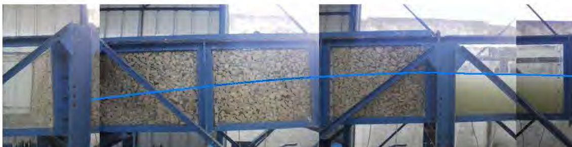
Figure1 : photo de l'essai I-1, Cailloux de diamètre moyen 0,05 m, pente = 5% et Q = 10 l/s)
