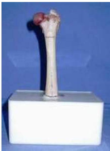
Figure 3 : Photographie montrant un fémur inclus dans un socle de résine
