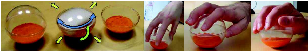
Figure 1. Disco est un dispositif à multiples degrés de liberté avec une base semi-sphérique inspirée du culbuto. Nous avons conçu différents facteurs de forme pour la moitié supérieure, de gauche à droite : Spherical, Rounded et Concave. Trois prises en main sont identifiées et étudiées dans l'article, de gauche à droite : Squeeze, Touch et Lay.
